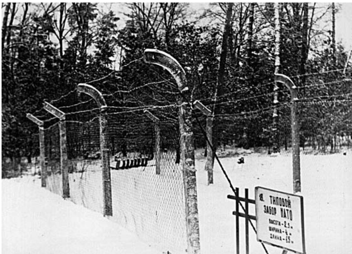
Рис. 18 типовой забор НАТО длина 15 м, высота - 2,5 м, ширина - 4 м
